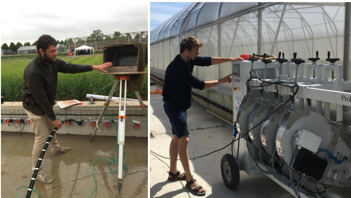
Figur 3: Optagelse af rødder med prototype til kamerasystemet (til venstre) og det endelige semiautomatiske kamerasystem med fire multispektrale kameraer der er udviklet til anlægget (til højre).
