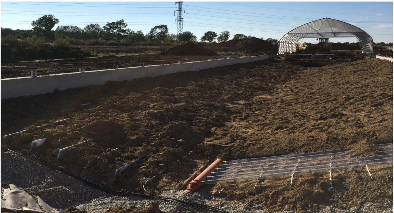
Figur 1: Et af karrene i Radimax fyldes med homogeniseret jord. De gennemsigtige plastrør, hvorigennem rodvæksten iagttages med et kamera ses i forgrunden.
