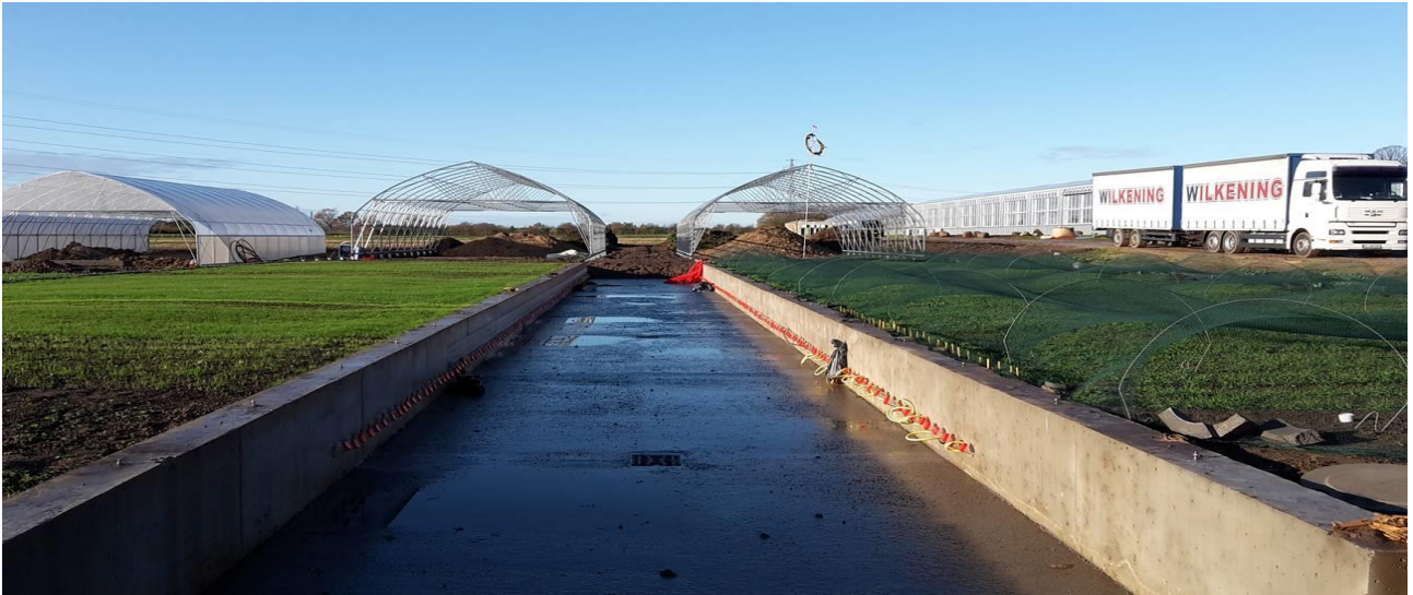
Figur 2: To af Radimax karrene med afgrøde. Plastrør til observation af rødderne ses med røde låg i betonkanterne, der er 150 plastrør i hvert kar. I baggrunden ses flytbare tag der sikrer at alt vand kan tilsættes nedefra via karrenes vandsystem.
